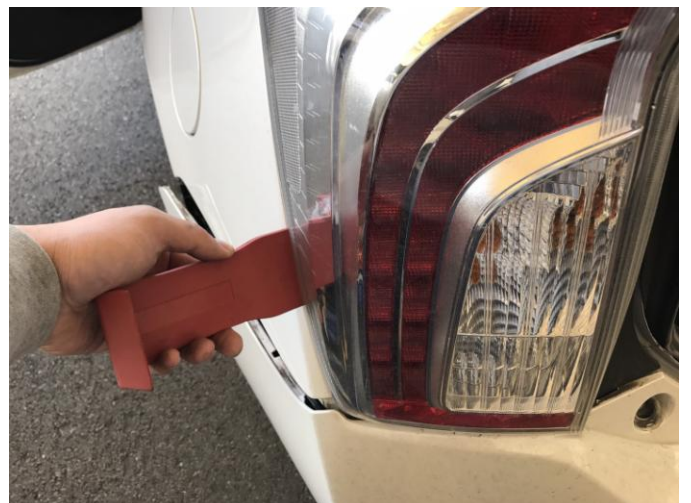
12.内張り外し等を用いてテールランプのロックを取り外します。
