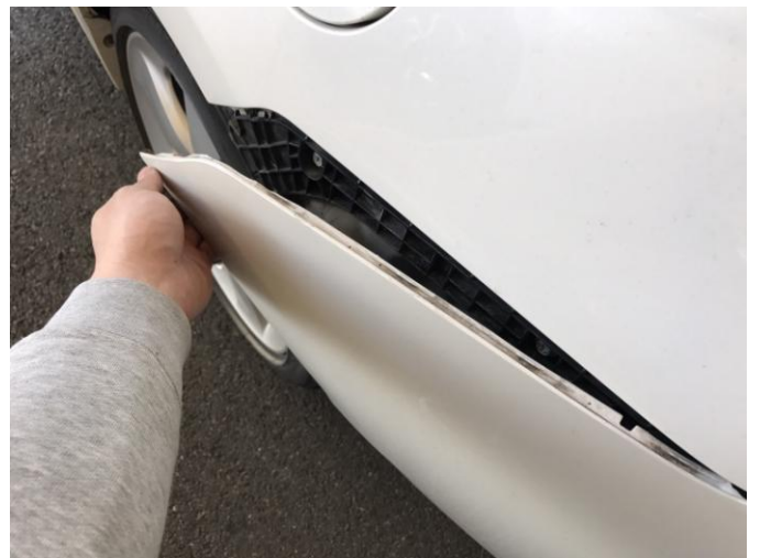
10.バンパーを剥がしていきます。
