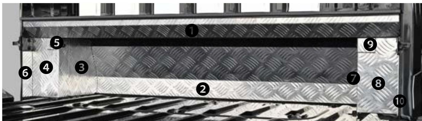
装着前に必ず脱脂作業を行ってください。両面テープが接する面には付属のプライマーを塗布してください。装着する際は②→③→⑤→④→⑥(反対は⑦→⑨→⑧→⑩)の順に張り合わせていただくことをお勧めします。※装着前に仮合わせを行ってください。
