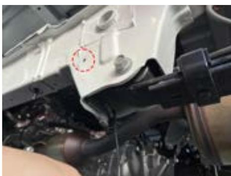
1, 脚付き特殊ボルト A をリーフスプリングの付け根から通し赤丸部の穴へボルトを通します。
