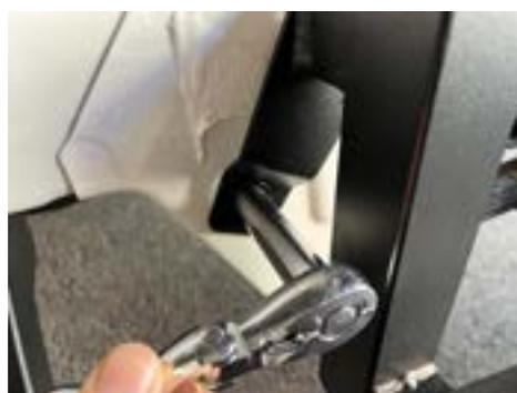
3, ボルトにワッシャー C、スプリングワッシャー D の順に通し、ナット E を 13mm のボックスレンチにて締め込みます。
