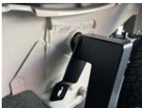
2, 本体の突起をフレーム側の穴へ挿し込みます。
