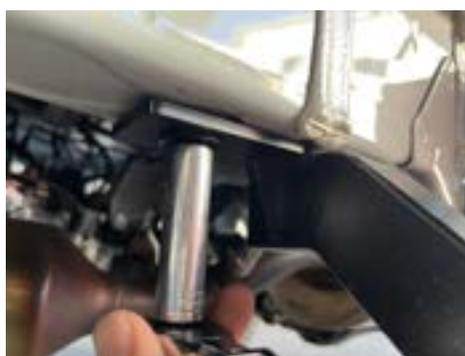
5, ボルトにワッシャー C、スプリングワッシャー D の順に通し、ナット E を 13mm のボックスレンチにて締め込みます。
