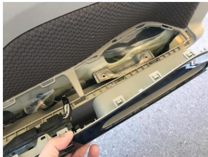
2. スイッチパネルを取り外します。内張り外し等を用いて外します。
