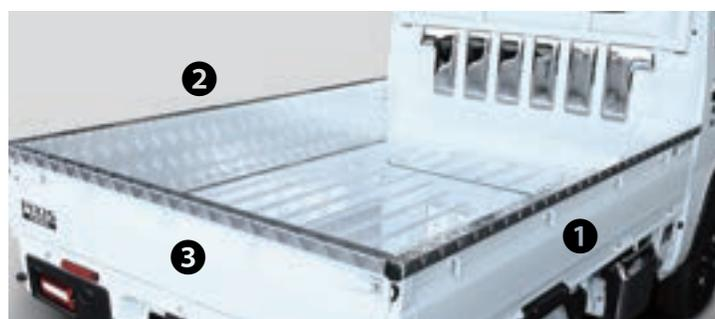
装着前に必ず脱脂作業を行ってください。両面テープが接する面には付属のプライマーを塗布してください。
