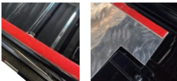
脱脂作業を行い、車両側アオリの上部と、製品側の下部に付属の両面テープを貼り付けます。両面テープの密着を高めるため、付属のプライマーを塗布してから貼り付けてください。
