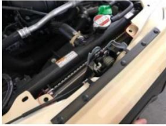
1. ラジエーター付近のプッシュピンを取り外します。
