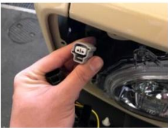
4. ウィンカーのカプラーを取り外します。
