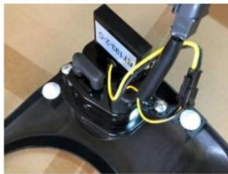
5. ウィンカー本体のビス2本を取り外し交換装着します。
