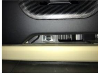
2. グリル下部の開口部のロックを解除します。
