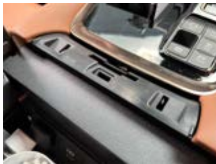
2. コンソールボックスを開け、手前にあるカバーを取り外します。
