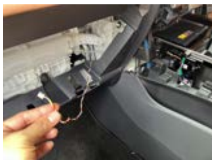
8. 製品側の配線をグローブボックス裏まで引きまわします。
