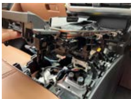
4. シフト周辺のパネルを外し、作業スペースを確保します。
