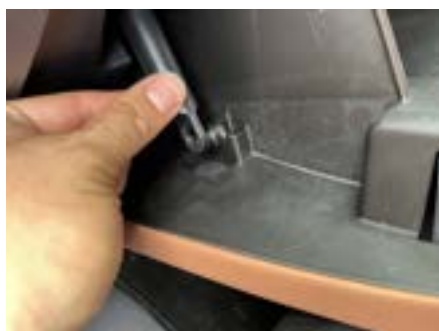
7. グローブボックスを取り外します。左側面のダンパーを取り外し、左右の爪を外し、本体を引き抜きます。
