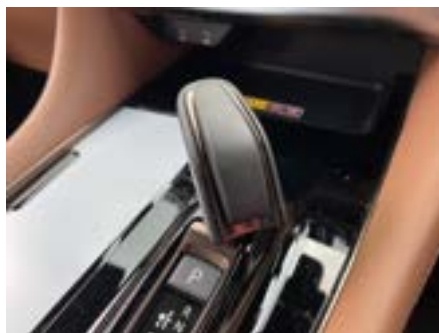
1. シフトノブを反時計回りに回し取り外します。
