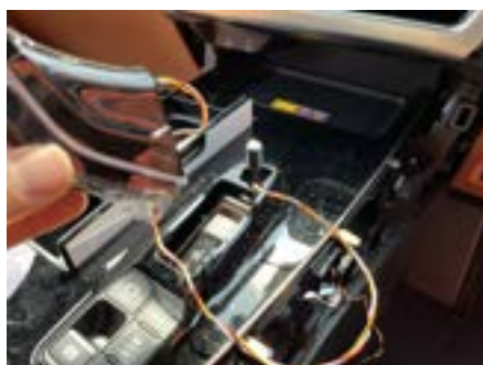
5. 製品の配線をシャフト部の穴に通し、配線を裏側に通します。
