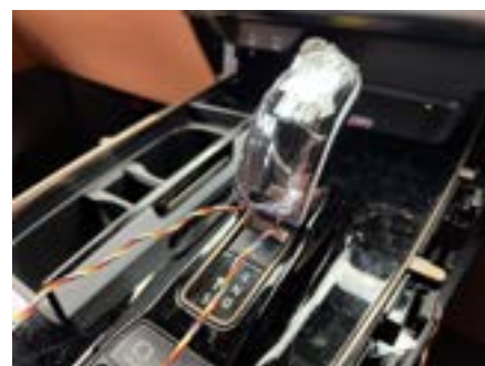
6. 配線がねじ切れないよう注意しながら製品を時計回りに回し固定します。後半はシフト周辺のパネルを取り付けた状態にて固定を行ってください。
