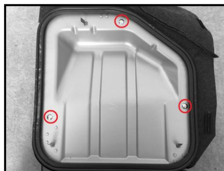
⑥遮熱材を取り外したら、○部分のビスを取り外します。
