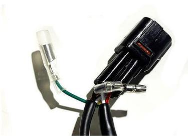
本製品は製品裏側のギボシ端子にて、点灯パターンの切り
