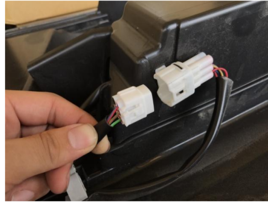
10 純正テールと同じ取り回しで配線をバンパーの裏側に取り出し、コネクタを接続し、逆の手順にてバンパーを戻してください。
