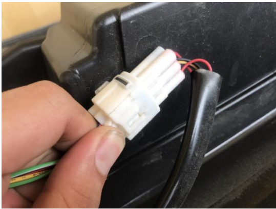
9.コネクタを取り外し、テール本体を表側より引き抜きます。
