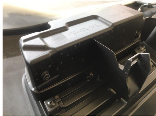
8.テール裏側下部のボルト(片側2か所)を取り外します。
