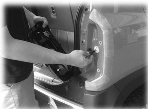
4. 黒いゴム製の防水キャップを取り外します。白い固定具は2か所の爪で固定されていますので、-ドライバーにて爪を押し取り外します。
