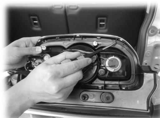
6. テールランプよりメッキリムを取り外します。6か所爪で固定されていますので、-ドライバーなどで押し、爪を順に外していきます。
