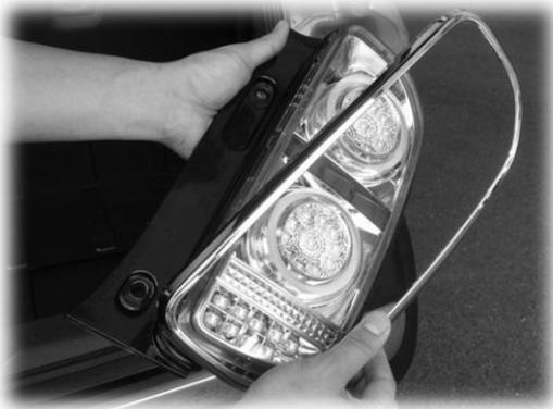
7.取り外した純正リムを本商品に付け替えます。各所に位置決めの引っ掛けがありますので、取り付け時にはリムが正しい位置にあることを確認しながら慎重に行ってください。
