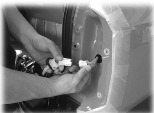
5. カプラーを取り外します。ロックがかかっていますので、固定具を押さえながら引き抜きます。
