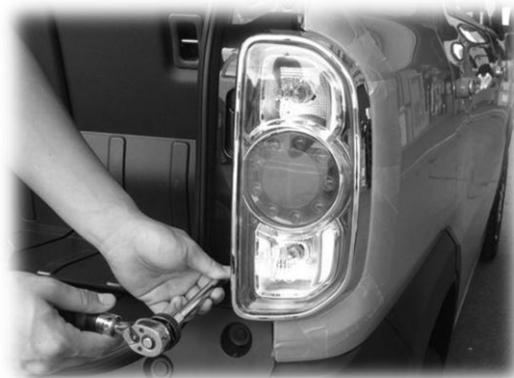
2. テールランプを固定する2か所のボルト(10mm)を取り外します。
