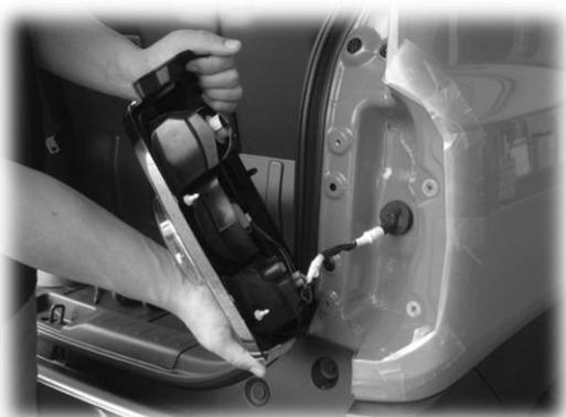
3. テールランプを後方へ引き抜きます。外側に2か所ピンがありますので力加減に注意して引き抜きます。
