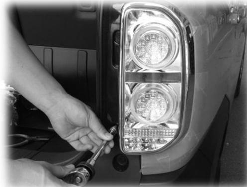
10.テールランプの外側の2か所のピンをはめ込み、内側の2か所のボルトを固定します。片側も同手順にて取り付けを行ってください。
