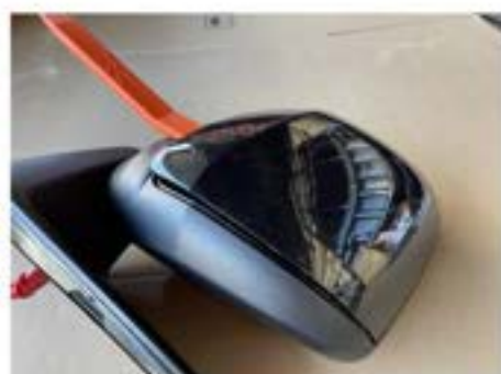
15. 裏側から爪を押し出し、表側よりリムーバー等を用いてカバーを浮かせるように取り外しを行ってください。
