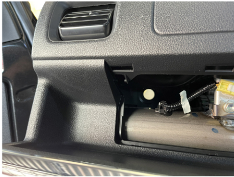
50, 助手席側トレイのカバーを取り外した奥に49の穴がございしますので、こちらから車内へ。配線を引き込みます。
