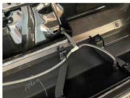
38. プッシュリベットが取り外せましたら、フードトリムを引き抜き、ウォッシャーのホースを取り外し、フードトリムを取り出します。
