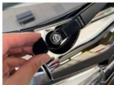
34. ワイパーを取り外します。キャップを取り外し、ナットを取り外し、本体を取り外します。
