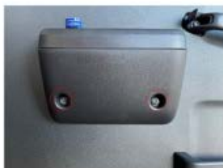
4. パワーウィンドウスイッチ部を固定するビス2か所を取り外します。
