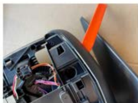
18. 裏側の爪を押ししながら、表側よりリムーバー等を用いて取り外します。
