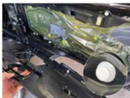
8. ドアトリムを引き剥がし取り外します。 ※ドア物に写真のようにクリップが残る場合がございますのでご注意ください。
