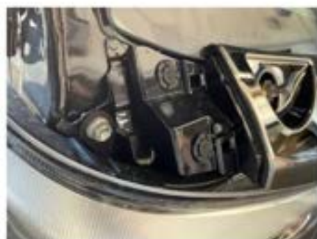
37. フードトリムを固定するプッシュリベットと、ヘッドライトを固定するボルトを取り外します。
