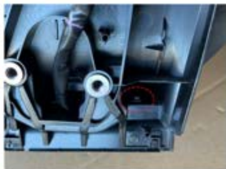
22. 根元の下側カバーを取り外します。裏側に爪が2カ所ありますので、爪を押し出し、取り外します。
