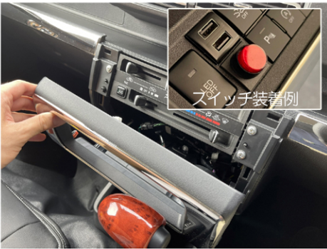
52, クラスタパネルを取り外します。 ※ウィンカーの切替スイッチは埋め込みが可能ですので、任意の位置へお取り付けください。
