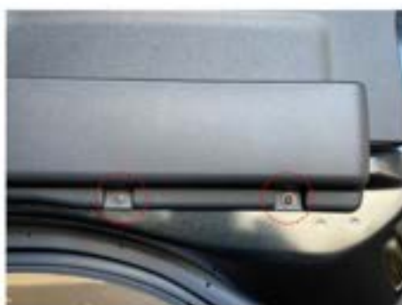
5. ドアポケット下部を固定するビス2か所を取り外します。
