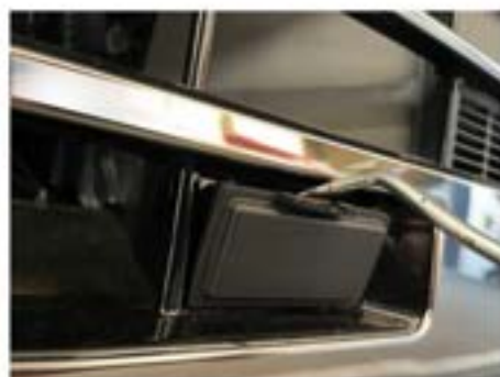
42. 左側のボルトカバーを取り外します。
