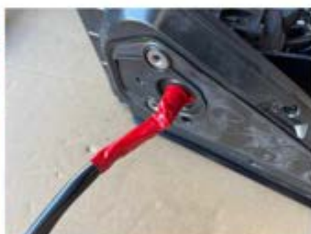
20. ドアミラー根本のテーピングを取り外します。
