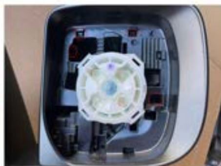
13. 裏側からドアミラーカバーの爪を押し出し、カバーを取り外していきます。
