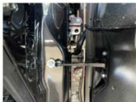
40. ドア内からヘッドライトを固定するナットとバンパーを固定するボルトを取り外します。
