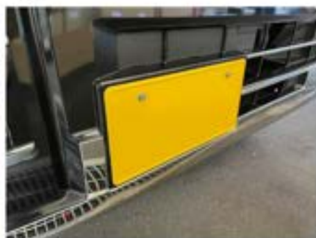
41. ナンバープレートを取り外します。
