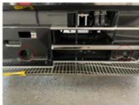
44. ナンバープレート裏側とカバー裏側のボルトを取り外します。
