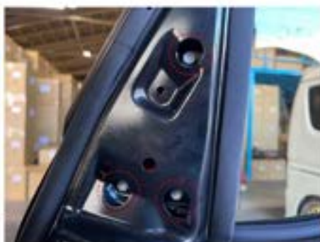
2. ドアミラー本体を固定するボルト3か所を取り外します。
