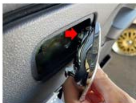
7. ドアハンドルに接続されたロッド(矢印部)を取り外し、ドアハンドル本体を取り外します。
