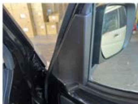
1. Aピラーカバーを取り外します。
