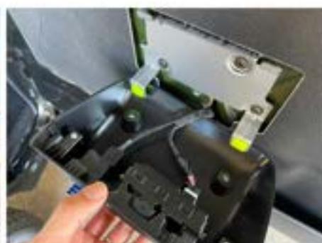
6. パワーウィンドウスイッチ部を上方に引き上げ、各部カバーを取り外し、本体ごと取り外します。
