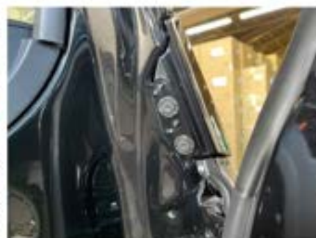
35. ドアをあけた状態でコーナーパネルを固定するプッシュリベットを取り外します。
