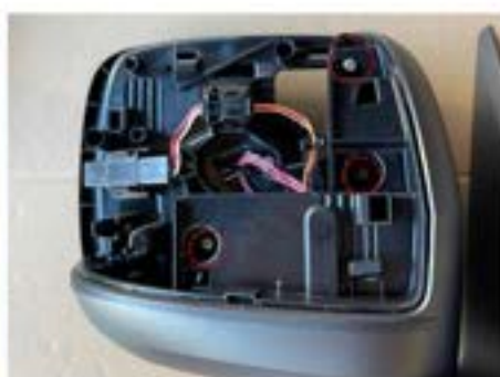
17. ロアカバーを取り外します。3か所のビスを取り外します。
