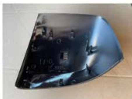
16. カバー裏の爪位置は写真のようになっております。 ※S500P後期ハイゼットトラックの例
