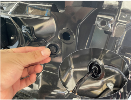
49, 助手席側/バルクヘッドにあるグロメットを使用し、車内側へハーネスを引き込みます。
