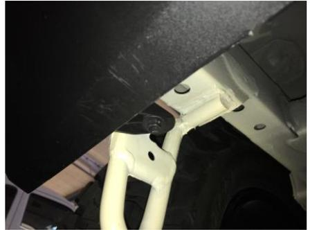
4.バンパー下部のボルトを取り外し、バンパーを車体から外します。
