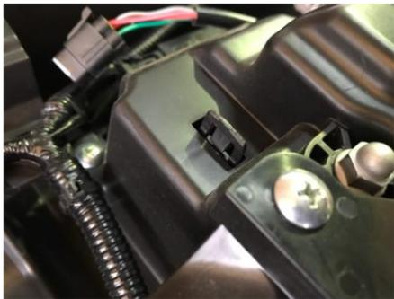
9.爪を押し込みバンパーからテールランプを引き抜きます。
