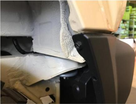
3.バンパー側面を固定するボルトを取り外します。
