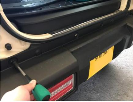
1.リアバンパーを固定するボルトを取り外します。
