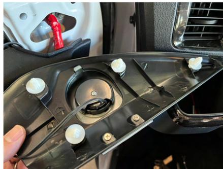
8. 本製品に純正のピラーカバーを固定するクリップを移植します。
