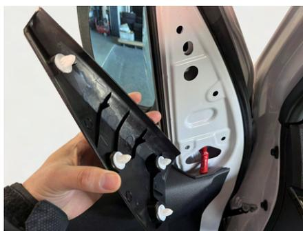
1. トリムリムーバー等を用いてAピラーのカバーを取り外します。
