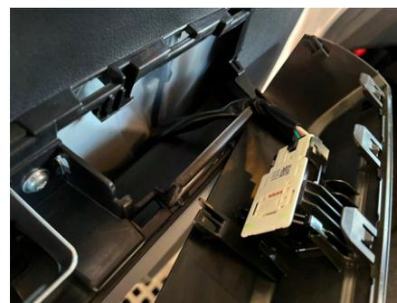
3. アームレスト部(パワーウィンドウスイッチパネル)カバーを取り外します。
