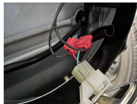
6. スピーカーの+極性側に黒線に白の印刷がある配線を接続し-極性側に黒線を接続します。
