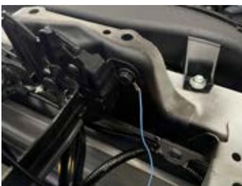
8. ヒンジを固定するボルトに製品のアース ( 青 ) を接続し、逆手順でパーツを戻します。
