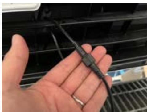
4. 配線を接続し、貼り付け面を脱脂し、両面テープにて本体を固定します。
