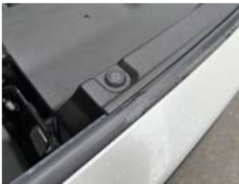
2. 前方にあるカウルを取り外します。プッシュリベットの中央を押し込み嵌合を外します。
