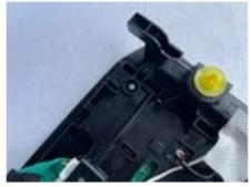
2. ルームランプの裏側より、嵌合の爪を押し外し、フレームとレンズを取り外します。
