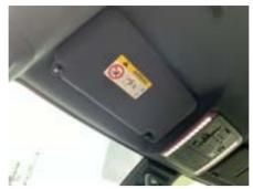
2. サンバイザー裏、フロントウィンドウの隙間に延長ハーネスを隠すように通します。
