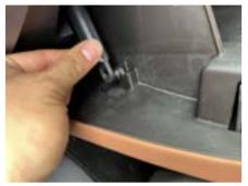
4. グローブボックスを取り外します。左側面のダンパーを取り外し、左右の爪を外し、本体を引き抜きます。
