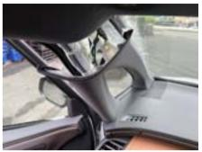
3. トリムリムーバー等を用いて A ピラーのトリムを浮かせ、ハーネスをグローブボックスの裏側へ通します。
