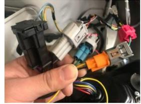
3.配線はすべてカプラーオンとなっていますので、純正品と差し替え装着します。
