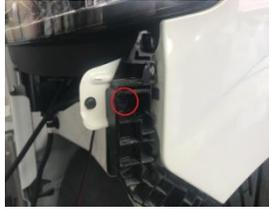
2.側面のボルト1本を取外し、ライト本体の脱着・固定が可能となっています。
