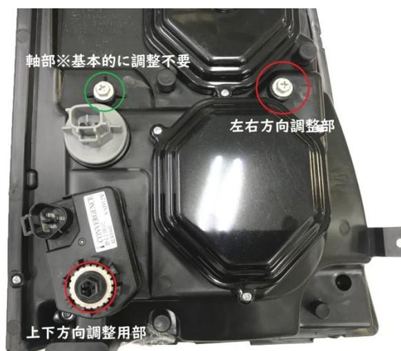
基本的に軸部の調整は行いませんが、調整の度合いにより、プロジェクターレンズがインナーと干渉する場合のみ、こちらの出幅を調整し、再度上下左右の調整を行ってください。
