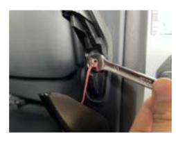
5.10mm のレンチにてボルト を締め付けます。
