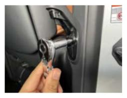
1.2 列目アシストグリップ下部 のカバーを外し、ボルトを取り 外します。
