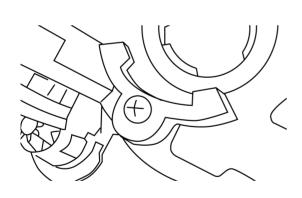
4. 変換カプラーを装着します。変換カプラーの 赤いツマミは抜け防止のロック機構になります。 解除した状態でバルブと接続し、差し込み後に ロックを行ってください。
