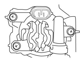
3. 本製品のフォグランプにバルブを装着します。※フォグランプ本体にビス止めされた固定具は本製品に付属のバルブでは不要となりますので、取り外してからバルブをお取り付けください。
