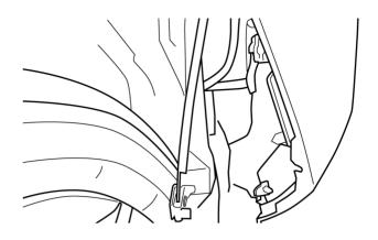
2. フォグランプの裏側で接続されているカプラーを取り外します。次にフォグランプを固定するビスを取り外し、バンパーからフォグランプを取り外します。
