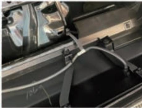
⑤ プッシュリベットが取り外せましたら、フードトリムを引き抜き、ウォッシャーのホースを外し、フードトリムを取り外します。
