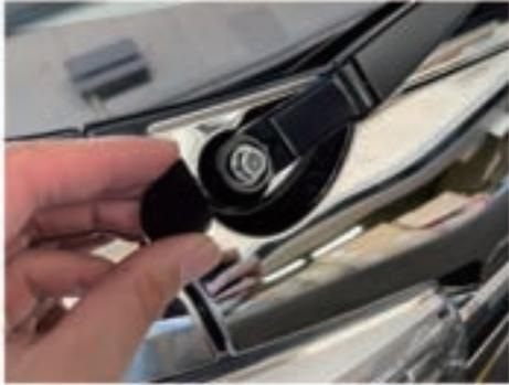
① キャップを取り外し、ナットを外してワイパー本体を取り外します。
