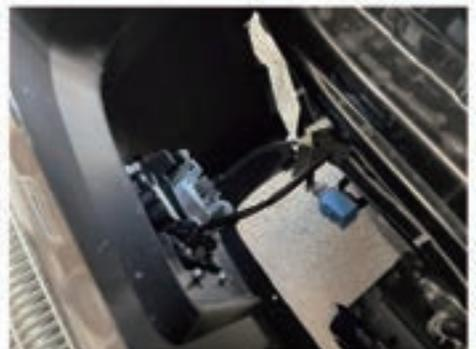
⑫ バンパーを手前に引き抜き、フォグランプ等のカバーを取り外し、バンパー本体を車体から取り外します。
