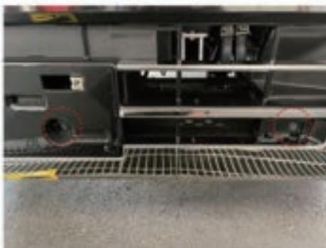
⑪ ナンバープレート裏側とカバー裏側のボルトを取り外します。
