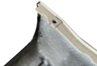
(B) 純正バンパーからスピードナットを移設し純正のボルトにて固定してください。
