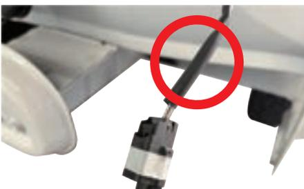
純正バルブ装着時には、配線の長さが短いため、延長加工が必須となります。純正カプラーに刺さる2本の配線をカットし、延長(約10cm程)を行ってください。
